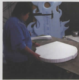
電熱ニクロム線で発泡を切る
